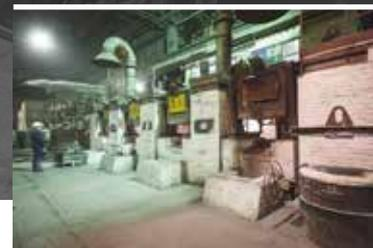
Технология газокислородного рафинирования стали – в конверторе ГКР, который позволяет вести выплавку уникальных сталей в полностью автоматизированном режиме.
